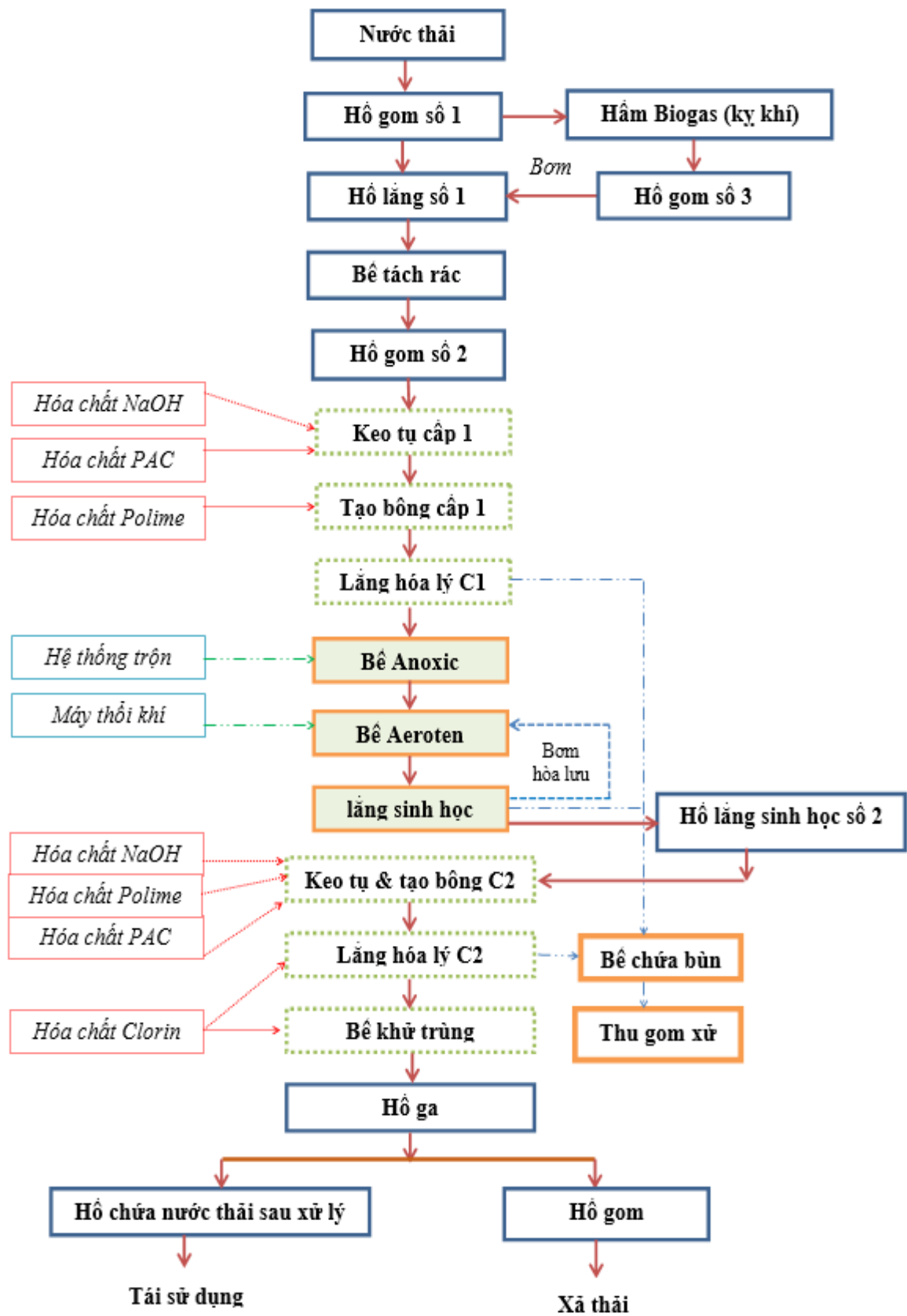
Hình 3.4. Hệ thống xử lý nước thải, công suất 150 m 3 /ngày.đêm
